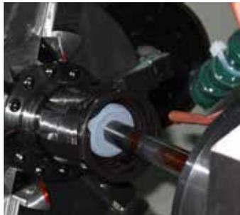
Exemple : contrôle de contact pour le centrage de la meule
