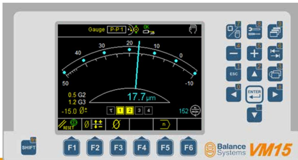
VM15 est un système modulaire programmable conçu pour les applications de complexité moyenne sur les rectifieuses, aux performances élevées et au coût contenu. Il fournit des solutions pour :
